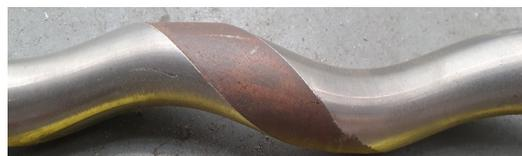
Примечание: разница между истиранием и износом металла: абразивный износ появляется вокруг линии уплотнения, в то время как износ металла создает плоскую поверхность на линии уплотнения
