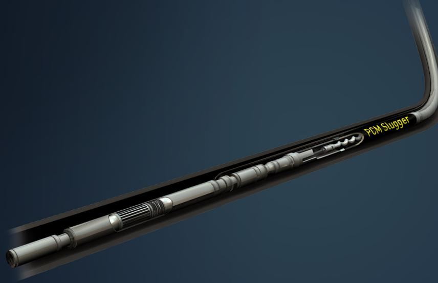
La bomba eléctrica sumergible de cavidad progresiva (ESPCP) es un SISTEMA SIN VARILLA que combina las ventajas de los motores ESP de fondo de pozo y los beneficios inherentes a la tecnología PCP.
